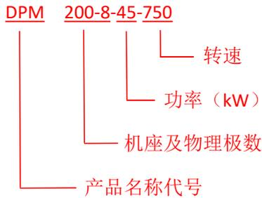
示例：机座号为 200，转速为 750r/min，功率为 45kW 的高效三相永磁同步电动机。表示为 DPM 200-8-45-750。
